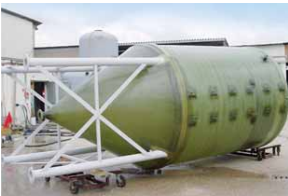
SEDIMENTATORE STATICO capacita 10.000 lt
