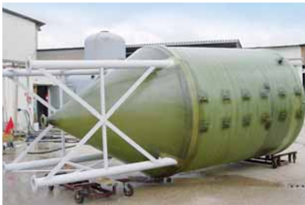
SEDIMENTATORE STATICO capacita 10.000 lt
